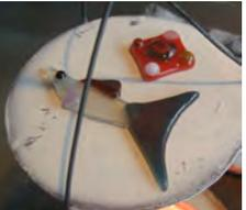
3 5分程で溶けたら、次は徐冷炉に入れてゆっくり熱を抜きます。
